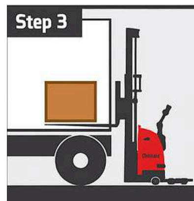
Las piernas del apilador se deslizan hacia atrás
