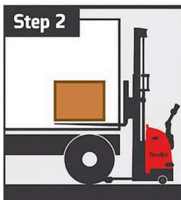
El apilador levanta la carga y la coloca en el camión
